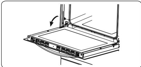
**2.**Den Sicherheitsbügel **a** mit einem Schraubendreher bis zum Anschlag öffnen.
