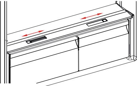
Bei vollem Gemüsefach sollte der Frischeregler vorne am Gemüsefach geöffnet werden. So kann die Luft und die Feuchtigkeit im Gemüsefach reguliert werden, um die Haltbarkeit der Lebensmittel im Fach zu verlängern. Wenn sich Kondenswasser am Glasablagefach bildet, muss der Frischeregler hinter dem Fach geöffnet werden.
