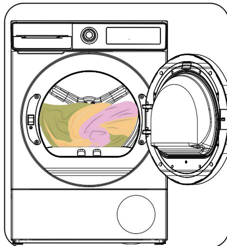
**WICHTIG!** Geben Sie nicht mehr Wäsche als in der Abbildung gezeigt in den Trockner. Bei Überladung verringert sich die Trocknungsleistung des Trockners und es kann zu Beschädigungen an der Kleidung kommen.
