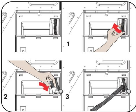
**⚠ ACHTUNG:** Der Schlauch muss so angeschlossen werden, dass er nicht verrutscht. Falls sich der Schlauch beim Ablassen des Wassers löst, könnte dies zu einer Überschwemmung führen.
