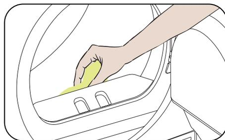
In der Maschine befinden sich Feuchtigkeitssensoren, die erkennen, ob die Wäsche trocken ist oder nicht.
