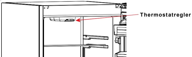
Das Thermostat regelt automatisch die Innentemperatur der einzelnen Fächer. Wenn Sie den Regler von Position 1 auf 5 drehen, erhalten Sie tiefere Temperaturen.
