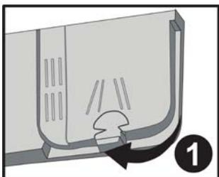
Schieben Sie die Verriegelung des Reinigerbehälters auf wie in der Abbildung gezeigt. **1** Der Reinigerbehälter besitzt im Inneren Markierungslinien. Es ist möglich, mit Hilfe dieser Markierungslinien die richtige Reinigermenge abzumessen. Der Reinigerbehälter kann insgesamt 40 cm<sup>3</sup> Reiniger fassen.
