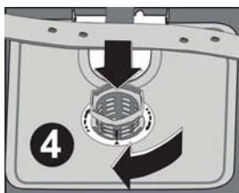
Metall-/Kunststofffilter heraus ziehen. 3 Dann den Grobfilter und den Microfilter heraus ziehen. 2 Gründlich unter fließendem Wasser abspülen. Metall-/Kunststofffilter wieder einsetzen. Den Grobfilter so in den Microfilter einsetzen, dass die Markierungen aufeinander abgestimmt sind. Den Microfilter in den Metall-/Kunststofffilter einsetzen und in Pfeilrichtung drehen. Die Einheit ist verriegelt, wenn der Pfeil am Microfilter von gegenüber gesehen werden kann. 4
