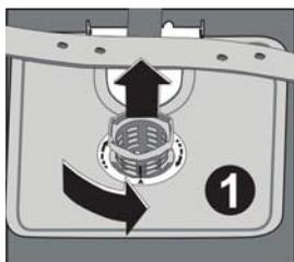
Zum Herausnehmen und Reinigen der Filterkombination diese im Uhrzeigersinn (nach rechts) drehen und nach oben heraus heben. 1
