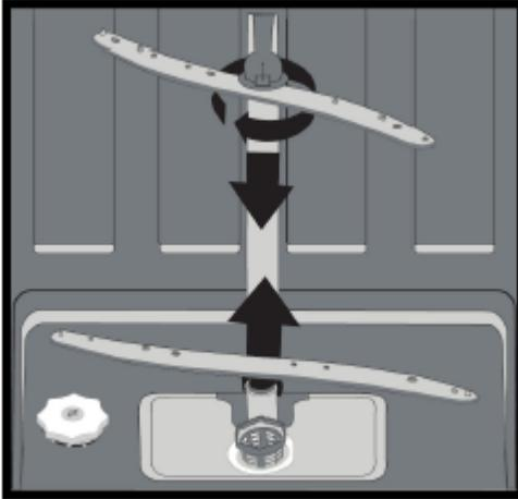
Prüfen, ob der obere und untere Sprüharm zugesezt ist. Sind die Sprüharme verstopft, die Sprüharme ausbauen und unter fließendem Wasser reinigen.
