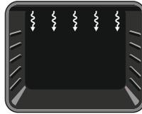
**Grill-Funktion:** Das Backofenthermostat und die Warnleuchten werden eingeschaltet, und das Grillheizelement beginnt zu heizen.
