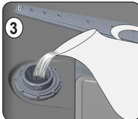
Um das Spezzialsalz einzufüllen, müssen Sie zunächst den unteren Geschirrkorb herausnehmen, damit Sie den Verschluss des Salzbehälters öffnen können, indem Sie den Deckel entgegengesetzt zum Uhrzeigersinn (nach links) abdrehen. **1 2** Füllen Sie zunächst das Fach mit 1 kg Salz und mit Wasser **3** bis zum Überlauf-Füllstand. Benutzen Sie, wenn möglich, einen Trichter **4** dadurch wird Ihnen das Befüllen erleichtert.
