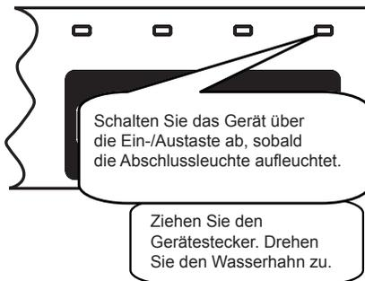
Ziehen Sie den Gerätestecker. Drehen Sie den Wasserhahn zu.
