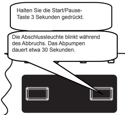
Schalten Sie das Gerät über die Ein-/Austaste ab, sobald die Abschlussleuchte aufleuchtet.
