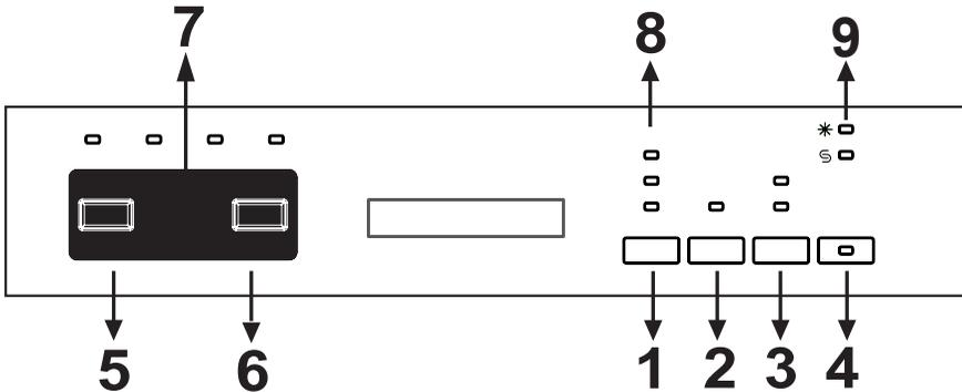
Sie können die Ein-/Aus-Taste (4) betätigen, um das Gerät auszuschalten. Die Ein/Aus-Leuchten leuchten, solange die Maschine eingeschaltet ist. Drücken Sie zum Einstellen des gewünschten Programms die Programmtaste (5).
