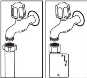
**HINWEIS:** Bei einigen Modellen wird ein Zwischenstück für den Aquastop verwendet. Bei Geräten mit Aquastop liegt gefährliche Spannung vor. Schneiden Sie den Schlauch nicht ab. Achten Sie darauf, dass der Schlauch nicht geknickt oder gequetscht wird.
