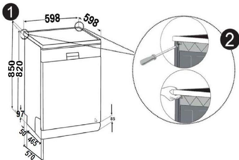
**Warnung:** Die Stelle, an der wir die Maschine durch Entfernen der Arbeitsplatte installieren, muss stabil sein, damit das Gerät gerade steht.
