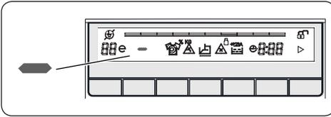
Die Schleuderdrehzahl lässt sich durch Betätigen der Schleuderdrehzahl-Einstelltaste schrittweise von der maximalen Schleuderdrehzahl bis zur Option „Kein Schleudern“ (-) reduzieren.
