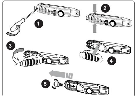
1. Lösen Sie die Schraube am Lampengehäuse mit einem Schraubendreher. (Abb. 1.)
