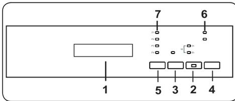
Schalten Sie die Maschine mit der Ein-/Austaste **(4)** ein. Die Ein-/Aus-Leuchte leuchtet, solange die Maschine eingeschaltet ist. Wählen Sie das geeignete Programm mit der Programmtaste **(5)**.
