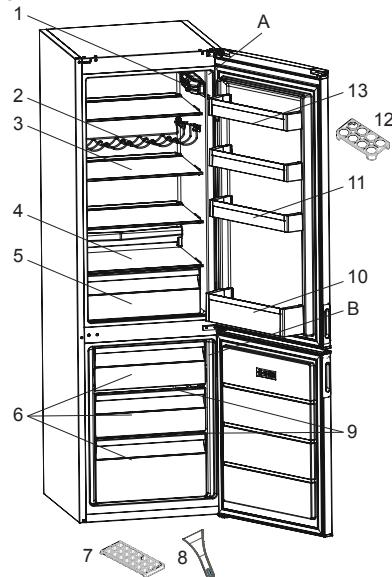
Die Abbildung stellt eine Übersicht über die Zubehörteile des Geräts dar. Die Zubehörteile sind je nach Modell unterschiedlich.
