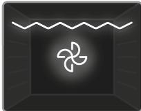
**Grill- und Umluft-Funktion:** Das Backofenthermostat und die Warnleuchten werden eingeschaltet, und das Grillheizelement sowie der Lüfter gehen in
