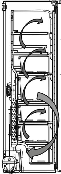
Dies ist bei Tiefkühlgeräten mit No-Frost-Technik völlig anders. Trockene und kalte Luft wird gleichmäßig von mehreren Stellen aus über ein Gebläse in den Tiefkühlbereich geblasen. Die kalte Luft wird dadurch gleichmäßig zwischen den Ablagen verteilt und kühlt Lebensmittel ebenso gleichmäßig, womit Feuchtigkeit und Vereisen verhindert wird.
