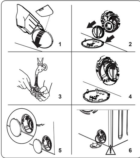
Das in Ihre Waschmaschine integrierte Flusensieb verlängert die Lebensdauer der Laugenpumpe, indem es das Eindringen von Flusen verhindert. Wir empfehlen, das Flusensieb alle 2 Monate zu reinigen.
