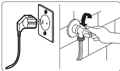
Schalten Sie Ihr Gerät aus und ziehen Sie den Stecker aus der Steckdose, bevor Sie Reinigungs- oder Wartungsmaßnahmen am Gerät durchführen.
