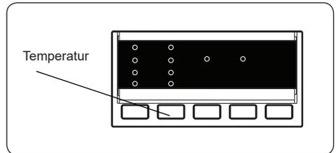
Betätigen Sie die Wassertemperatur-Einstelltaste, um die automatisch eingestellte Temperatur des jeweiligen Waschprogramms zu ändern.
