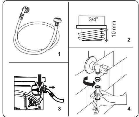
1. Ihr Gerät verfügt je nach Modell entweder über einen einfachen Zulaufanschluss (kalt) oder einen doppelten Zulaufanschluss (warm und kalt). Der Schlauch mit der weißen Kappe muss an den Kaltwasserzulauf und der Schlauch mit der roten Kappe an den Warmwasserzulauf angeschlossen werden (sofern zutreffend).
