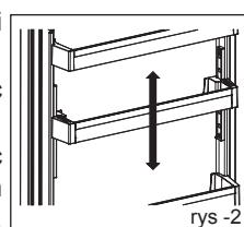
**Uwaga:** Przed zmianą położenia obciążonej półki podeprzyj ją od spodu. W przeciwnym razie pod wpływem dodatkowego obciążenia może spaść z szyn. Może to spowodować uszkodzenie szyn lub półki.
