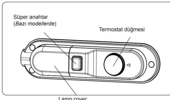
Termostat düğmesi, buzdolabınızın sıcaklık ayarının (soğutucu ve dondurucu bölmesi için) otomatik olarak yapılmasını sağlar. 1 ve 5 değerleri arasında istenilen herhangi bir değere ayarlanabilir. Sıcaklık ayar düğmesini 1'den 5'e doğru çevirdikçe soğutma derecesi artar. Normal kullanım için önerilen ekonomik konum 3'dür. Kış aylarında enerji tasarrufu sağlamak amacıyla dondurucunuza daha düşük konumda (1 veya 2 arasında) çalıştırılabilirsiniz.
