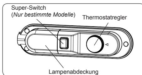
Das Thermostat regelt automatisch die Innentemperatur der einzelnen Fächer. Wenn Sie den Regler von Position 1 auf 5 drehen, erhalten Sie tiefere Temperaturen.
