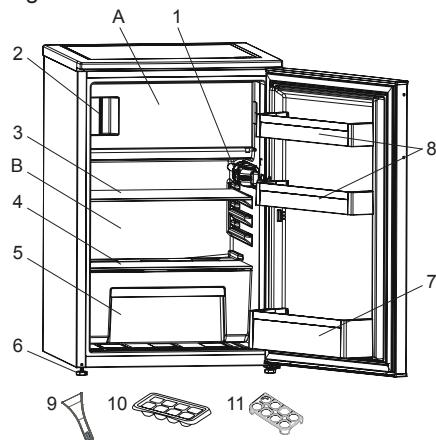
Die Abbildung stellt eine Übersicht über die Zubehörteile des Geräts dar. Die Zubehörteile sind je nach Modell unterschiedlich.
