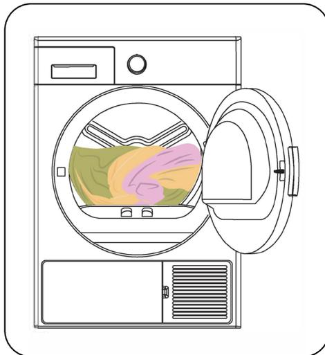
**⚠ Wichtig:** Sie sollten den Trockner nicht mit mehr als der in der Abbildung angegebenen Wäschemenge beladen. Bei Überladung lässt die Trocknungsleistung nach und Trockner und Wäsche könnten beschädigt werden.
