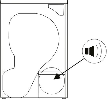
A line drawing of a washing machine drum. A circular area at the bottom right is highlighted with a black circle. An arrow points from this circle to a speaker icon (a trapezoid with two curved lines) inside another circle, indicating the source of the noise.           | <p><b>Pumpgeräusche</b></p> <p>Die Pumpe wird beim Einschalten der Maschine und zu bestimmten Zeiten während des Betriebs aktiviert. Während dieser Vorgänge ist es normal, Pumpen- und Wassergeräusche zu hören.</p> |
