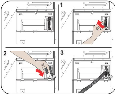
**ACHTUNG!** Der Schlauch muss so angeschlossen werden, dass er fest sitzt. Falls sich der Schlauch beim Ablassen des Wassers löst, besteht Überschwemmungsgefahr.
