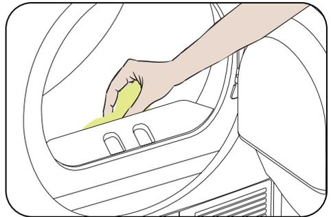
Im Gerät befinden sich Feuchtigkeitssensoren, die erkennen, ob die Wäsche trocken ist.
